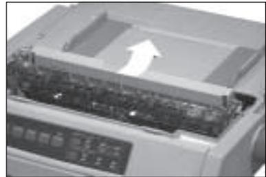
4. Setzen Sie die Zufuhrschiene
