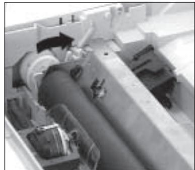
1. Setzen Sie den Einzelblatteinzug mit den Befestigungsbügeln beidseitig auf die Druckwalzenwelle auf, so dass er fest aufsitzt.
