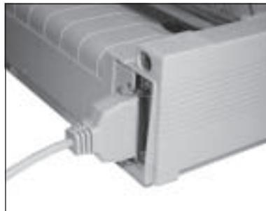
Paralleles Schnittstellenkabel und Anschluss
