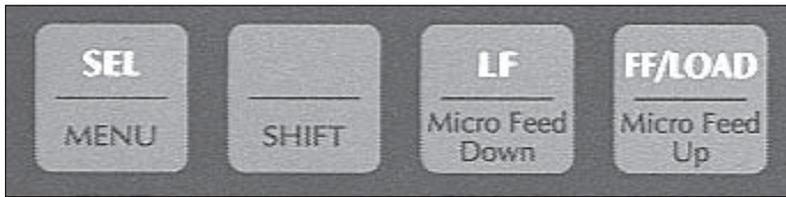
*Micro Feed Down:* Das Papier wird in Schritten von 1/180 Zoll rückwärts (nach unten) transportiert. Drücken Sie gleichzeitig die *SHIFT*- und die *Down*-Taste, um die Funktion »Micro Feed Down« nutzen zu können.
