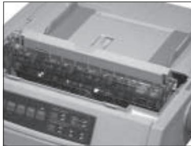
3. Lösen Sie nun die Verriegelung des Druckkopfes, indem Sie den Hebel nach oben ziehen und die Verriegelung zur Seite klappen.
