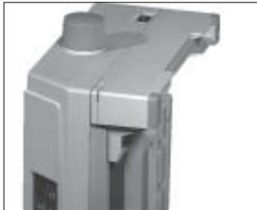
5. Entfernen Sie vor der Installation des linken Ständerfußes vorübergehend den Walzendrehknopf, damit er nicht beschädigt wird. Stellen Sie den Drucker auf die rechte Seite, um den linken Ständerfuß entsprechend zu installieren.
