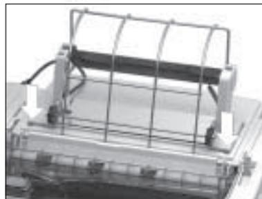
3. Öffnen Sie das Kläppchen oberhalb der Schnittstellenanschlüsse und verbinden Sie den Kabelstecker des Rollenpapierhalters mit der nun sichtbaren Buchse des Druckers. Der Pfeil auf dem Anschlussstecker muss dabei zur Druckeraußenseite weisen.
