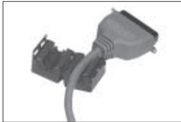
2. Schließen Sie die Hülle durch Zuschnappen, das Kabel ist somit entstört.
