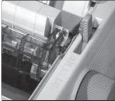
3. Klappen Sie die Papierauflage nach oben, indem Sie sie hinten hochziehen und in die Halterung gleiten lassen.
