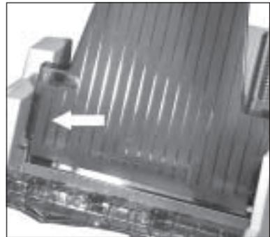
7. Für eine einwandfreie Papierzufuhr und -verarbeitung muss der Papierwahlhebel an der rechten Druckerseite auf das Einzelblattsymbol (mittlere Position, TOP) weisen.
