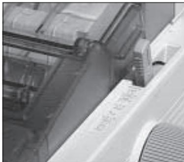
3. Schieben Sie das Endlospapier durch den Zufuhrschlitz im Druckerboden bis auf Höhe der Druckwalze. Ziehen Sie das Papier dann nach oben bis über den Zugtraktor weiter.
