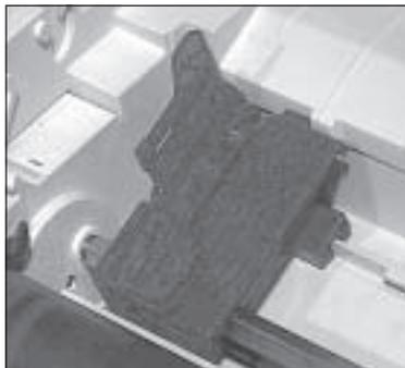
5. Setzen Sie das Endlospapier in die ersten Transportstacheln ein und schließen Sie die Abdeckung wieder.
