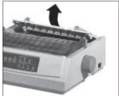
4. Installieren Sie nun den Zugtraktor auf dem Drucker. Setzen Sie dabei die Nut an beiden Seiten des Zugtraktors in die Stifte der Halterung am Drucker ein (Pfeil).
