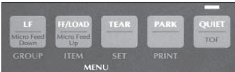
*LF*: Mit dieser Taste (Line Feed) wird das Papier eine Zeile vorwärts transportiert. Ist ein Einzelblatteinzug (Zubehör) installiert und befindet sich noch kein Papier vor der Druckwalze, wird bei Betätigung dieser Taste ein neues Blatt Papier aus dem aktuellen Papierschacht bis zur ersten bedruckbaren Zeile eingezogen.
