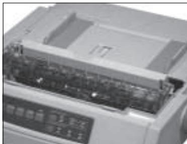
4. Fassen Sie die verbrauchte Farbbandkassette an der oberen Seite an und ziehen Sie sie vorsichtig nach oben über den Druckkopf ab.
