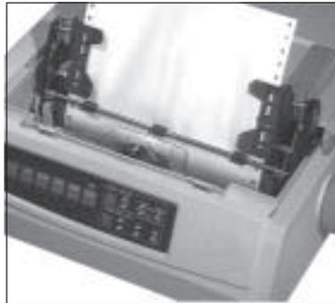
8. Schalten Sie den Drucker ein. Der Druckkopf bewegt sich an den linken Rand der Druckwalze, und die aktiven Anzeigen des Bedienfeldes leuchten auf.
