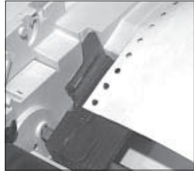
6. Stellen Sie nun den rechten Stachelriemen entsprechend der Papierbreite in der oben beschriebenen Weise ein. Öffnen Sie die Abdeckung des rechten Stachelriemens, setzen Sie das Endlospapier in die ersten Transportstacheln ein und schließen Sie die Abdeckung.
